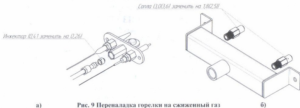
Рис. 9 Переналадка горелки на сжиженный газ
